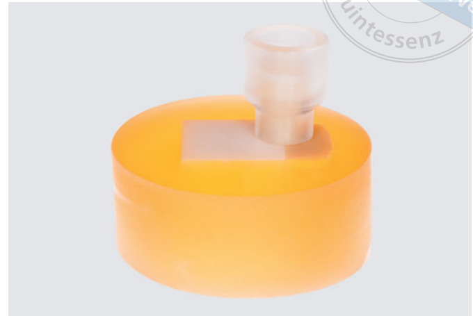
Abb. 8 Hülse zur Reparatur der Prüfkörper.
